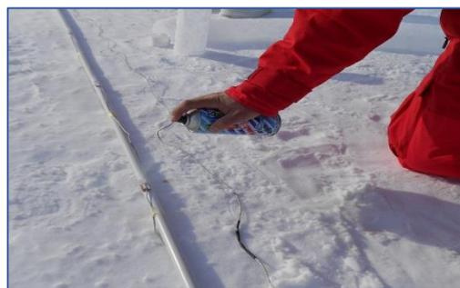
Fig. 2 – preparazione all'installazione della sonda multisensoriale
